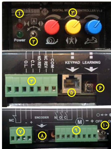
شکل شماره ۲- اجزای کنترل درب
